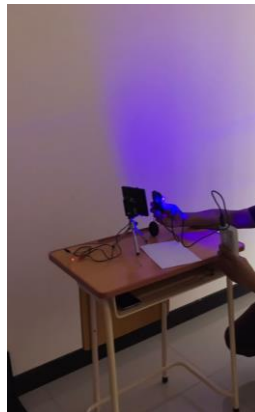
Gambar 7. Pengujian prototipe awal Optical Wireless Transfer Energy, dengan Fluxmeter dan Multimeter.
