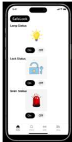
Gambar 4. Desain Dashboard IoT Sistem Pemantauan RFID Lock Door
